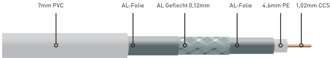
Hochwertiges 3-fach geschirmtes Koaxialkabel mit 1.02 Stahl-Kupfer-Innenleiter. Dieses Kabel wurde entwickelt um ein optimales Preis-Leistungsverhältnis zu erreichen, unter Vorgabe der Klasse A nach DIN 50117. Es ist uns gelungen sehr gute elektrische Werte zu erhalten durch eine hochwertige Rosendahl Produktion mit sehr homogenem, physikalisch geschäumten PE.
